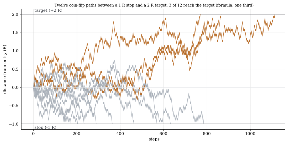
Abb. 1: Zwölf simulierte Zufallswege zwischen einem Stop bei -1 R und einem Ziel bei +2 R. Die orangen Wege erreichen das Ziel, die grauen den Stop. Die Formel sagt ein Drittel.
